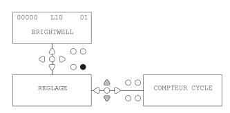
Afin de vérifier que l'ensemble des entrées requises reçoivent des signaux (et pour détecter les entrées qui reçoivent plusieurs signaux), le logiciel Brightlogic fournit un écran TEST DES IMPULSIONS.
