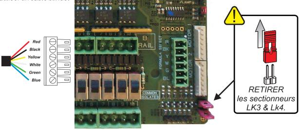
Montez le connecteur vert avec les fils de couleur dans l'ordre indiqué ci-dessus. Enfoncez le connecteur dans la prise correspondante et resserrez le presse-étoupe pour bloquer le câble.
