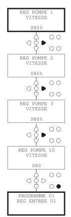
A partir de l'écran VALVE DE RINCAGE - DUREE (ou de l'écran AFFECTATION DES BLOCS si les valves de rincage ne sont pas nécessaires), appuyez sur la touche **AVANCE/ACCEPTATION** pour passer à l'écran VITESSE DE POMPE/DEBIT.
