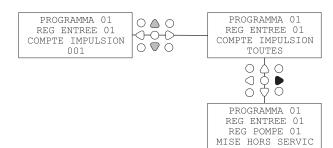
Par défaut, l'ensemble des pompes seront initialement réglées sur "DESACTIVATION" sur l'ensemble des entrées.
