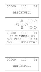
Pour accéder au MODE TEST, mettez d'abord l'unité hors tension. Ensuite, tout en maintenant la touche *TEST* enfoncée, remettez l'unité sous tension. Lorsque l'unité se sera déclenchée, elle sera en MODE TEST.
