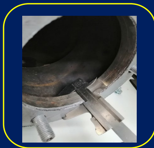
SPESSORE FLANGIE . CIELO . FONDO 2 cm THICKNESS FLANGES . UP SIDE . BOTTOM 0,8 INCHES EPAISSEUR BRIDES . CIEL . FOND 2 cm
