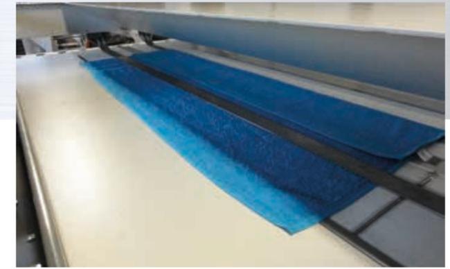
également d'identification automatique de l'article. Dans les plis longitudinaux, on peut réaliser 1 ou 2 plis. Si on veut uniquement des plis transversaux (par exemple pour des tapis de bain), on a la possibilité de ne pas plier dans le sens de la longueur. Malgré ses dimensions extérieures compactes, la FlexFold AT230 peut traiter des articles qui font jusqu'à 230cm de longueur.
