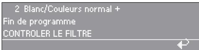
Le message "Contrôler le filtre" apparaît lorsque le filtre doit être nettoyé. Effectuer le nettoyage juste après la fin du programme.
