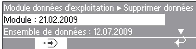
L'option module permet d'effacer l'"ensemble des données" et les "données de programme" des données d'exploitation.
