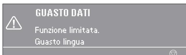
Le anomalie che dovessero verificarsi dopo l'avvio del programma vengono segnalate lampeggiando sul display.
