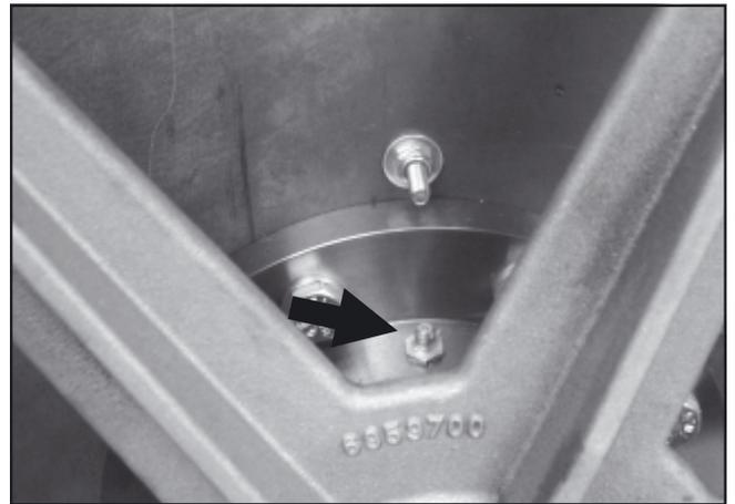
Dévisser la vis de purge d'air avant le graissage. Les **paliers d'arbre de tambour** gauche et droit doivent être graissés environ toutes les 1000 heures de fonctionnement par le graisseur avec de la graisse **Arcanol L 100**. Il faut faire décrire trois rotations au tambour pendant le graissage. Eliminer l'ancienne graisse qui est sortie.
