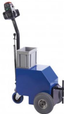
Azur Concept Blanchisserie vous propose ce tracteur électrique Easy Power de chez **Sclessin**, vous permettant de tracter plus d'une tonne (le matériel à tracter doit être équipé d'une barre d'attelage).
