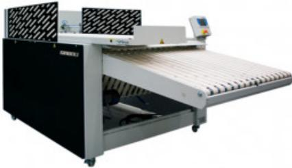
Azur Concept Blanchisserie a sélectionné cette plieuse **FT SERIES** de **GIRBAU**. Cet équipement professionnel permet un pliage longitudinal et transversal avec empilage de qualité.
