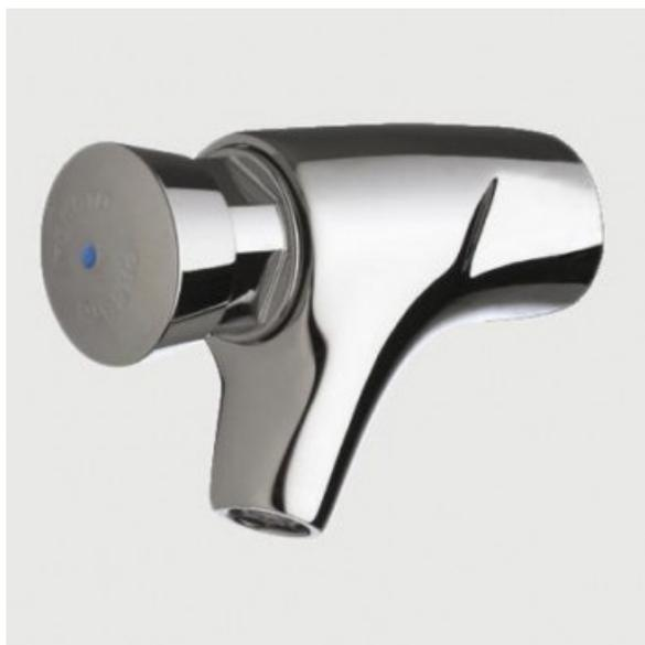
Azur Concept Blanchisserie vous propose ce ROBINET SIMPLE PRESTO 504S. Le mitigeur sur plage pour lavabo permet l'ouverture d'eau par simple pression sur le bouton-poussoir. L'eau s'arrête automatiquement après une temporisation réglée en usine. Idéal pour les collectivités et hôtels de plein air.
