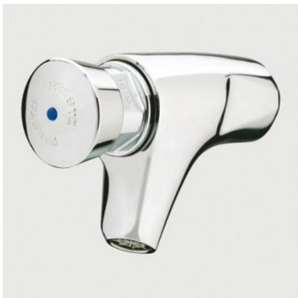
Azur Concept Blanchisserie vous propose ce ROBINET SIMPLE PRESTO 504. Le robinet mural permet l'ouverture d'eau par simple pression sur le bouton poussoir. L'eau s'arrête automatiquement après une temporisation en usine de 15 secondes. Un filet d'eau continu évite la formation du gel.
