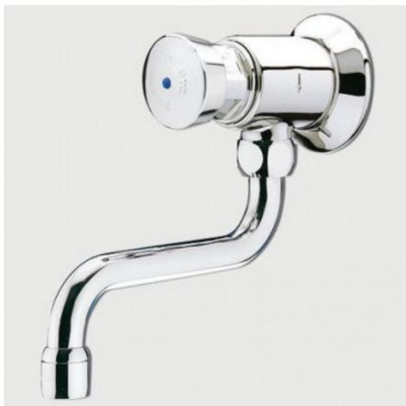
Azur Concept Blanchisserie vous propose ce ROBINET SIMPLE PRESTO . Le robinet tempormural pour lavabo permet l'oulement d'eau par simple pression sur le bouton poussoir. L'eau s'arre automatiquement apr une temporisation rl en usine 15 secondes.
