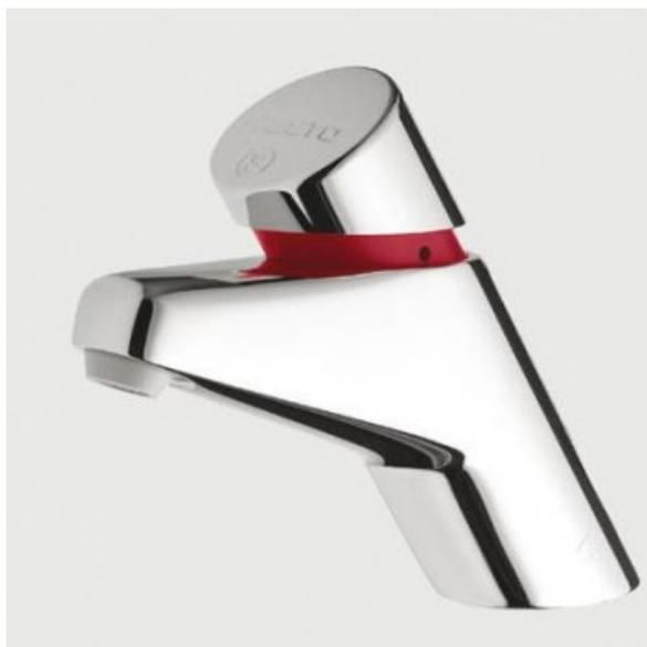
Azur Concept Blanchisserie vous propose ce ROBINET SIMPLE SUR PLAGE PRESTO . Le robinet mural permet l'oulement d'eau par simple pression sur le bouton-poussoir. L'eau s'arre automatiquement apr une temporisation rl en usine 15 secondes. Avec le syste S, il faut relher le bouton poussoir pour que l'eau coule.
