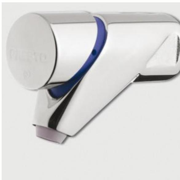
Azur Concept Blanchisserie vous propose ce ROBINET SIMPLE MURAL PRESTO. Le robinet mural pour lavabo permet l'oulement d'eau par simple pression sur le bouton-poussoir. L'eau s'arre automatiquement apr une temporisation rl en usine 15 secondes. Avec le syste S, il faut relher le bouton poussoir pour que l'eau coule.
