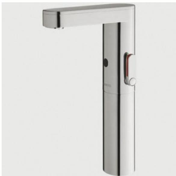
Azur Concept Blanchisserie vous propose ce ROBINET MITIGEUR SUR PLAGES PRESTO. Le mitigeur optoelectronique pour lavabo permet le déclenchement de l'écoulement d'eau par une simple détection des mains sous le robinet et son arrêt automatique de leur retrait. Le temps de la suralimentation est de 30 secondes.
